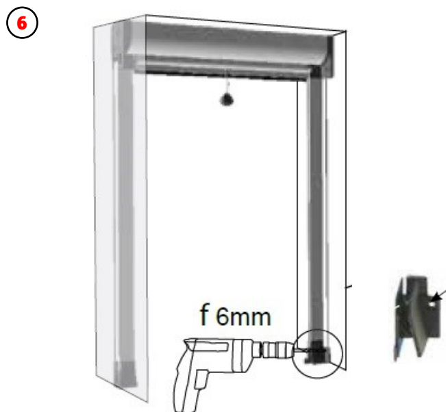
Vérifier le niveau de vos coulisses droite et gauche. Marquer les trous à gauche et à droite, percer avec un foret de 6 mm. Insérer les chevilles et viser avec la visserie fournie.
