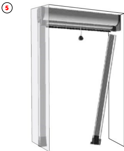
Insérer les embouts de pied de coulisse gauche et droit et positionner les coulisses dans les caches joues comme sur la photo.
