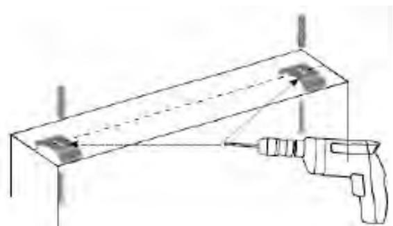
Percer avec un foret de 6 mm le jambage supérieur de votre tableau en alignant les crochets métalliques. Une fois les trous effectués placer les chevilles et visser les crochets métalliques à l'aide des vis fournies. Vous pouvez maintenant clipper le caisson.
