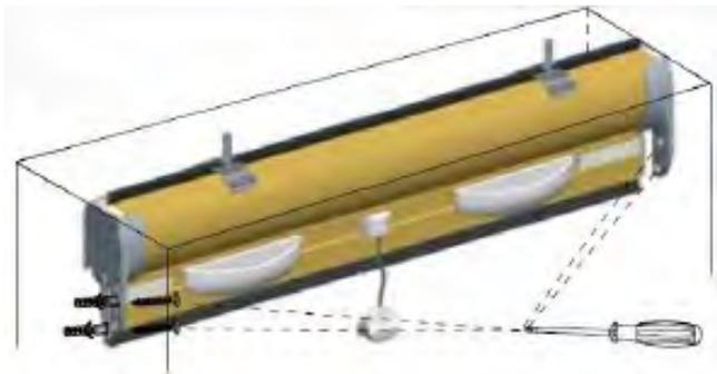
Une fois le caisson clipper, marquer avec un crayon les points à percer sur les fixations latérales. Une fois les points marquer, enlever le caisson et percer avec un foret de 6 mm puis replacer le caisson avec les vis fournies.
