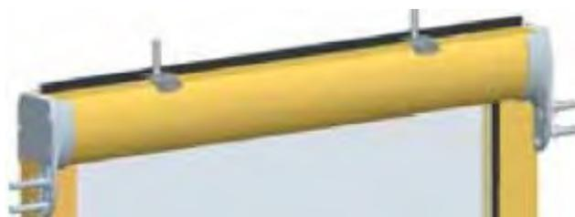
Insérer les coulisses dans le caisson, percer les coulisses avec un foret de 4 mm à une distance de 10 cm du haut et du bas de la coulisse. Percer votre tableau avec un foret de 6 mm, insérer les chevilles et fixer avec les vis fournies.
