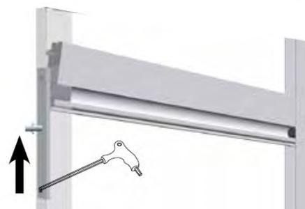
Une fois la moustiquaire en place, poussez vers le haut la platine de verrouillage jusqu'à ce que la moustiquaire repose sur le linteau. Une fois positionné comme il faut serrez la vis . A faire des deux cotés.
