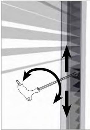
Descendre la barre de charge de la moustiquaire jusqu'au rebord de la fenêtre, puis tendre la platine de réglage de fils pour ajuster l'horizontalité de la barre de charge.
