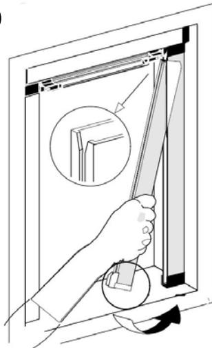
Insérer la contre coulisse dans la coulisse en faisant attention d'avoir l'extrusion en V en haut de coulisse. (Voir schéma ci-dessus).
