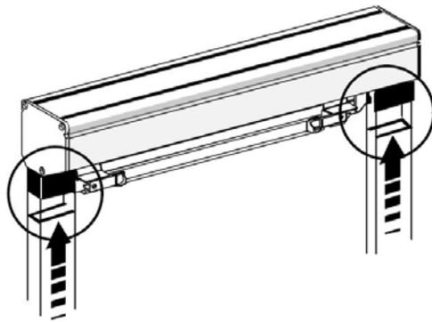
Positionner vos coulisses dans les « blocages de coulisse du caisson ». (Voir schéma ci-dessus).
