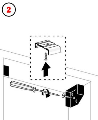
Positionner vos joues gauche et droite . Percer puis fixer les joues gauche et droite à l'aide des chevilles et vis fournies. Selon la situation de pose, et la taille du caisson, il vous sera fourni à la place des joues latérales, des équerres de fixation sur linteau.
