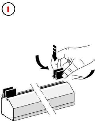
Insérer les blocages de coulisse dans le caisson. (Voir schéma ci-dessus).
