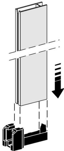
Insérer l'embout de pied de contre coulisses au bas de la contre coulisse. **ATTENTION** les contre coulisses ont un sens. L'extrusion en V est le haut de la contre coulisse.
