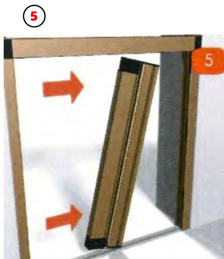
Positionnez le caisson dans les clips du profil de support de caisson. Vérifiez le bon fonctionnement.
