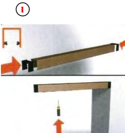
Insérez les joints brosses dans le profil supérieur et positionnez les 2 joes aux extrémités. La joue la plus grosse se positionne coté caisson.
