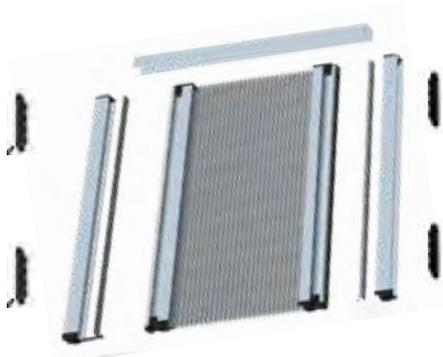
Fixer les crampillons au mur de chaque côté dans l'axe du rail haut et seuil bas. Insérer la moustiquaire et les profils muraux dans le rail haut et dans le seuil bas. Clipser les profils muraux dans les crampillons.
