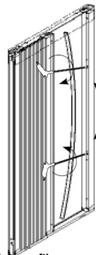
Vérifier qu'aucun fils ne se retrouve bloqué dans les angles. Pour régler la tension des fils, retirer l'aimant sur le profil mural droit puis tendre (sans forcer) les platines inférieures et supérieures de façon à ce que les fils soient tendus.
