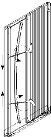
Vérifier qu'aucun fils ne se retrouve bloqué dans les angles. Pour régler la tension des fils, retirer l'aimant sur le profil mural gauche puis tendre (sans forcer) les platines inférieures et supérieures de façon à ce que les fils soient tendus.
