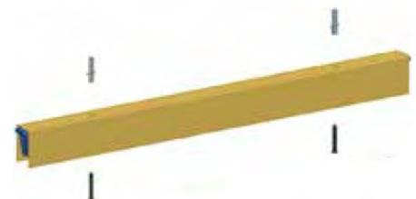
Fixer le rail haut et vérifier que les baïonnettes soient bien plaquées au mur pour accueillir les profils muraux. Si ce n'est pas le cas dévisser la vis grain et pousser les baïonnettes contre le mur.
