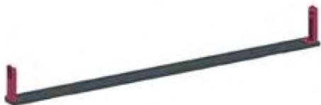
Positionner le seuil bas et vérifier que le seuil bas se trouve bien dans le même alignement que le rail haut puis le coller à l'aide du double face installé dessus. Une fois collé pousser les baïonnettes contre le mur.
