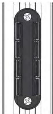
Placer les plaques de fixation **8** bien alignées au centre du profil de compensation **3** et les visser à intervalle régulier avec la vis pour plaque **9**
