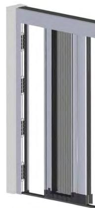
Insérer le bloc toile dans le rail haut, puis appuyer le corps de la moustiquaire fermement afin de clipper le montant fixe dans les plaques de fixation
