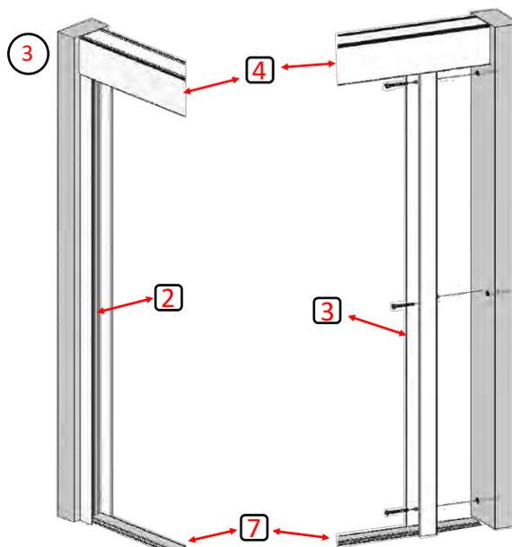
Après avoir fixé le rail haut et le seuil, placer le profil de compensation entre les deux et le fixer au mur avec vis et chevilles. Reproduire la même chose avec le profil de réception avec aimant.
