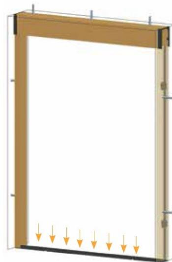
Une fois les profils latéraux fixés, vous pouvez coller le guide inférieur au sol en prenant soin d'enlever la bande de protection du double face.
