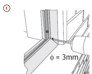
Positionner votre moustiquaire et repérer les fixations dans les angles. Percer avec un foret de 3 mm sur de la menuiseries aluminium. Visser directement sur de la menuiserie bois.
