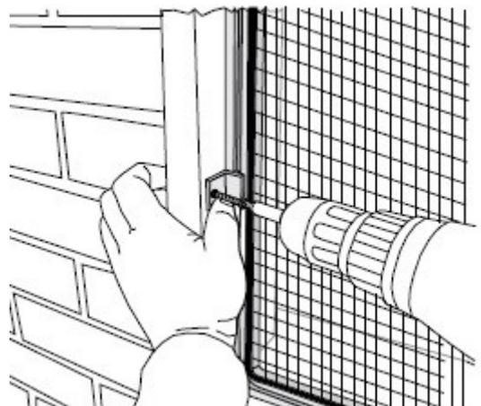
Positionner votre moustiquaire et percer avec un foret de 6 mm l'emplacement des équerres. Insérer les chevilles et visser.
