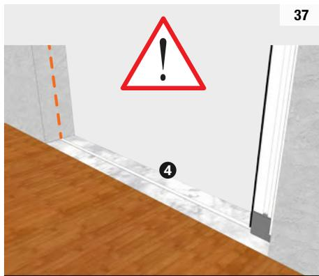
En option : seuil plat de guidage recommandé pour une largeur > 2000 mm.
