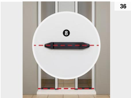
Plaque de guidage au sol pour la jonction des 2 vantaux. Dégraisser et sécher la surface de fixation avant de coller le ruban adhésif double face.
